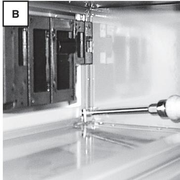
**B** Befestigungsschrauben im oberen Kasten abschrauben.
