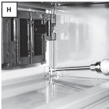
**H** Befestigungsschrauben im oberen und unteren Kasten anschrauben.
