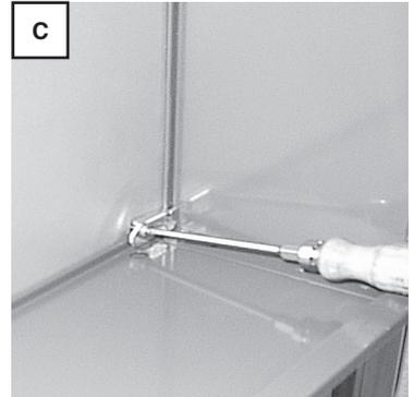
**C** Befestigungsschrauben im unteren Kasten abschrauben.
